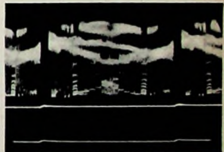
Bild 4. Oszillogramm des Universal-Testbildes über das Bild
